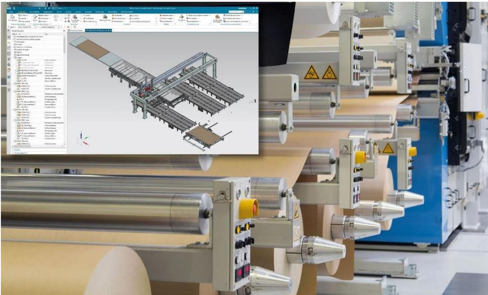
*Mit dem Mechatronics Concept Designer lassen sich die komplexen Druck- und Pressenanlagen der Hymmen GmbH inklusive Automatisierungstechnik simulieren. (Quelle: Hymmen GmbH Maschinen- und Anlagenbau)*
