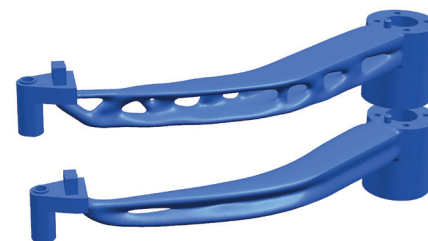
Die Ergebnisse der Topologieoptimierung können mit Convergent-Modeling-Techniken kombiniert werden, um das Design weiter zu verfeinern.
